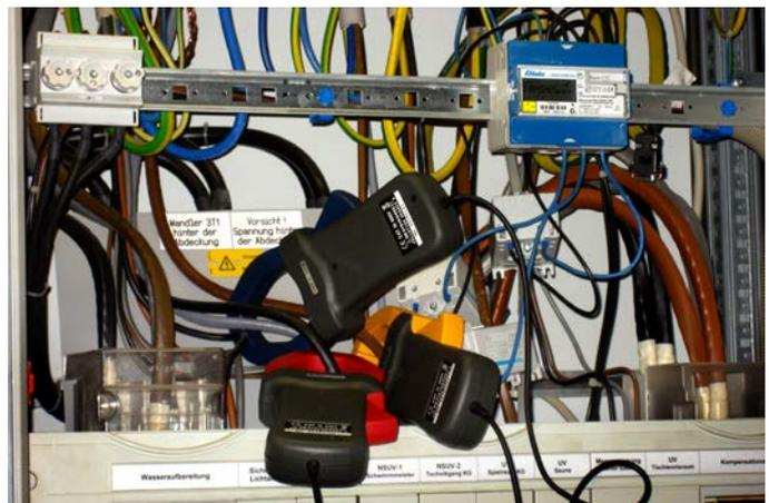
Abb. 7: Messaufbau zur Strommessung
