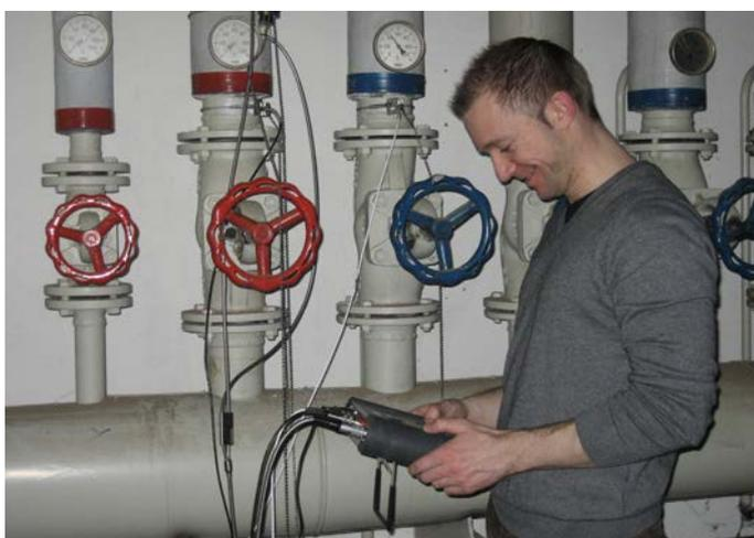
Abb. 8: Messaufbau zur Wärmestrommessung
