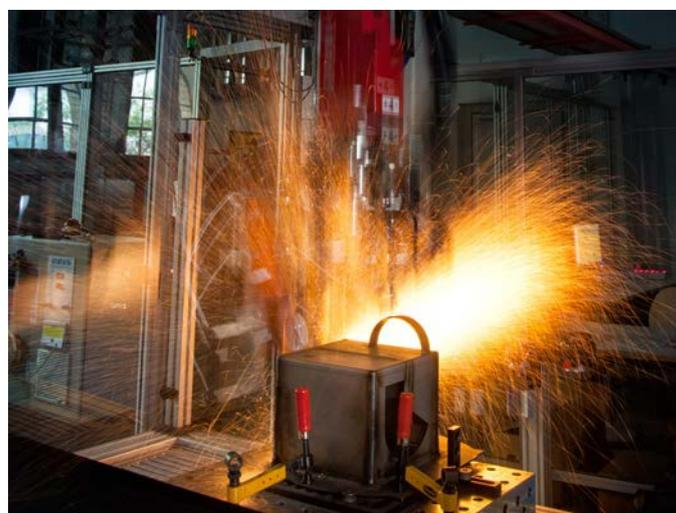
Abb. 6: Links: Untersuchung des Störverhaltens der Kraftregelung durch Abfahren eines Sinusprofils. Rechts: Anwendung der entwickelten Kraftregelungsalgorithmen auf das Schleifen mit Industrierobotern.
